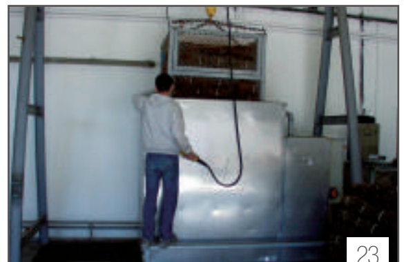
Appareil de traitement à l'eau chaude en fonctionnement (cliché ENTAV)
