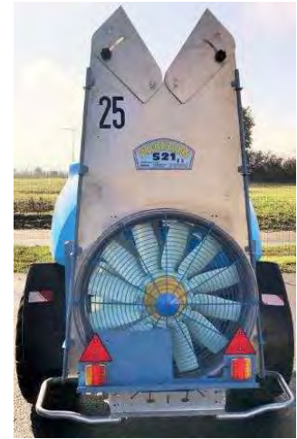
S21 – Double turbine vergers voûte droite
