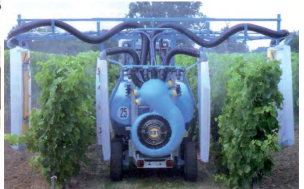
S21 - Tunnel de pulvérisation
